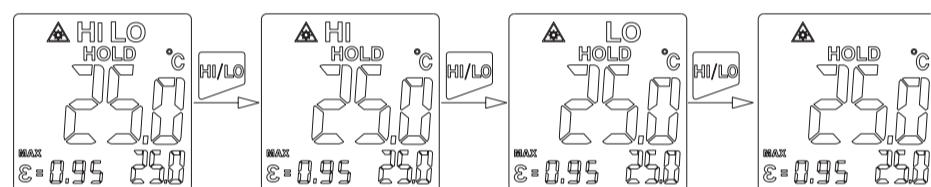
当相应的限值报警功能打开时，测温过程中温度超出所设限值后就会报警，如果所测温度值高于所设置的HIGH限值红色LED和显示器上HI图标会闪烁报警；所测温度值低于所设置的LOW限值蓝色LED和显示器上LO图标会闪烁报警。
