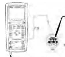
图12LOOP测量端口接线
