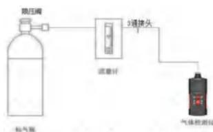
**警告：非专业人员严禁进行此操作，否则一切后果自行承担！检测仪在出厂时已统一进行过标定测试，如果用户想重新进行标定，请严格按照步骤，先零点校准（如果修改过零点微调值，需要把微调值改为0）后进行重新浓度校准。用户如误操作此设置，请及时恢复出厂设置。**
