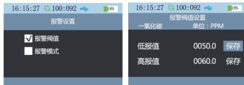
**报警阀值：**当处于报警阀值设置界面时，移动焦点选择需要修改的高报值或者低报值。用户可按下“”键后对数值进行操作，通过“◀”和“▶”键来切换光标选中一位数值，“▲”和“▼”对数值进行加或减，当数值设置完成后按下“OK”键确认，通过“◀”和“▶”键将光标移至保存处，再次按下后方可保存，此时系统提示保存成功并语音提示“保存成功”。按下“”键返回上一级菜单。
