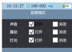
**报警模式：**检测仪的报警方式有三种可选，分别为声音、震动、灯光报警，本公司气体检测仪出厂时报警方式默认全都开启，用户可根据实际需要自行调整。
