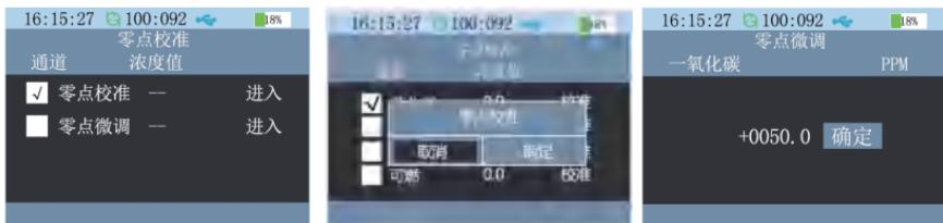
零点设置栏下包括零点校准和零点微调两个子选项。
