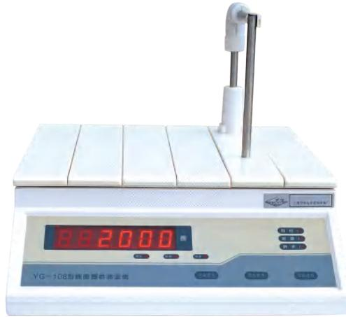
YG108系列仪器用于测量各种类型线圈圈数，例如发电机绕组、变压器线圈、继电器线圈、电视机高低压包绕组、汽车点火器等各种类型线圈，测量精度高。
