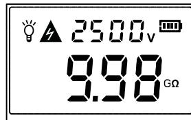
4. 松开测试键，此时仪器会自动释放测试所产生的高压，高压指示灯灭，高压警报“嘀、嘀”声消失，待LCD屏幕显示“0V”时方可拆除表笔线，此时LCD屏幕显示测试的绝缘电阻值，如下图所示:
