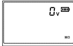
3. 把测试表笔或夹子连接到被测物，按下测试旋钮，进入测试状态，此时蜂鸣器会间歇地发出“嘀、嘀”声，高压指示灯亮，测量过程中LCD屏幕显示以下内容:
