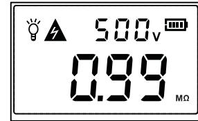
直至把测试按钮以逆时针方向旋转并且将它恢复到原来的位置，高压指示灯灭，高压警报“嘀、嘀”声消失，仪器将一直处于测量状态，解除测量按钮后仪器会自动释放测试所产生的高压，待LCD屏幕显示“0V”时方可拆除测试线，此时LCD屏幕显示如下图所示：
