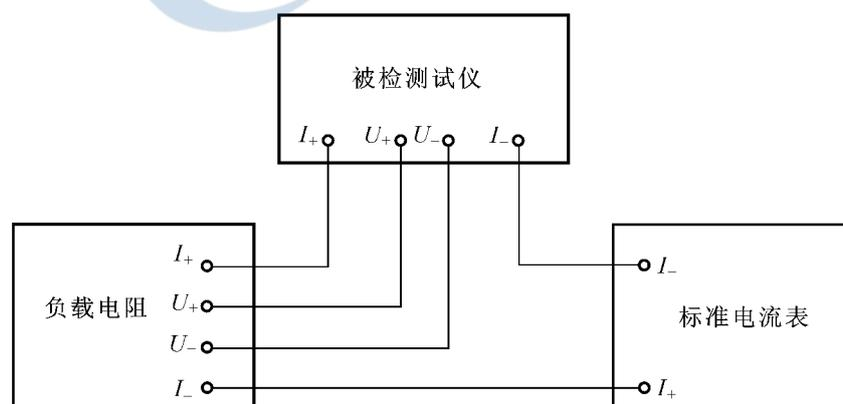
图5 标准电流表法检定测试仪器试验电流设置（调节）误差的原理图
