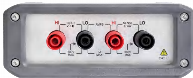
图 3-3-2 USB7065 前面板连接器接口
