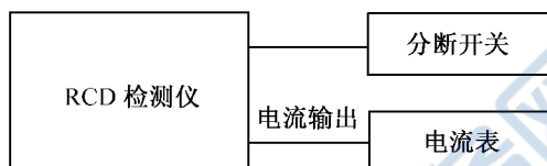
图 2 离线检测型 RCD 检测仪校准
