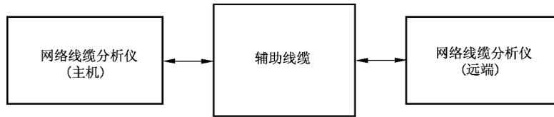
图 12 网络线缆分析仪主机和远端同时测量
