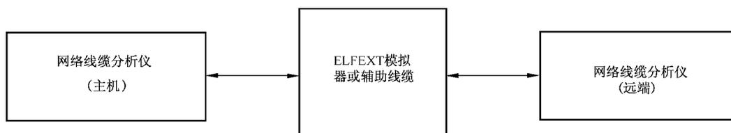
图 8 网络线缆分析仪主机和远端同时测量
