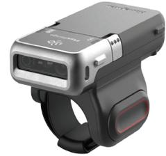
8675i可穿戴扫描器结构坚固，外形紧凑，符合人体工学设计，扫描性能好，可在严苛的工作流程中可靠运行，提高实际应用的生产力。
