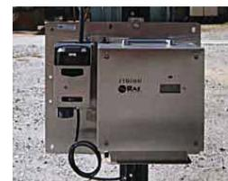
PowerPak connecté au détecteur MeshGuard. Le détecteur est présenté dans le boîtier de protection en acier inoxydable, fixé à la plaque de montage
