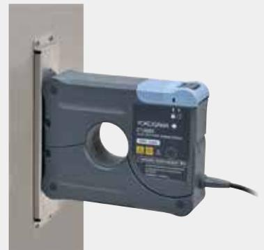
主单元可用螺丝固定，通过稳定的测量提高再现性。
