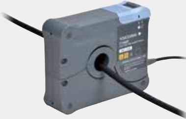
轴位置固定夹具可抑制测量线的晃动，减少对测量值的影响。
