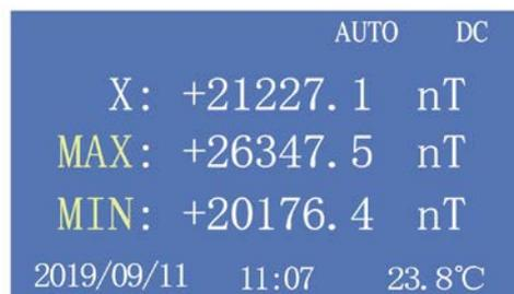
一维显示：彩屏显示为数字模式，VGA 显示器整屏显示 X/Y/Z 轴当前量程、测试数据及谷峰参数。N/S 极性由正负号表示，极性 N:+ S:-。
