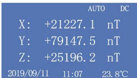
三维显示：第 1 条框显示当前量程和测量模式，第 2 条框显示 X 轴测试数据，第 3 条框显示 Y 轴测试数据，第 4 条框显示 Z 轴测试数据，最下行显示日期，时间，温度（如使用带温度传感器探头显示探测点温度）等参数。
