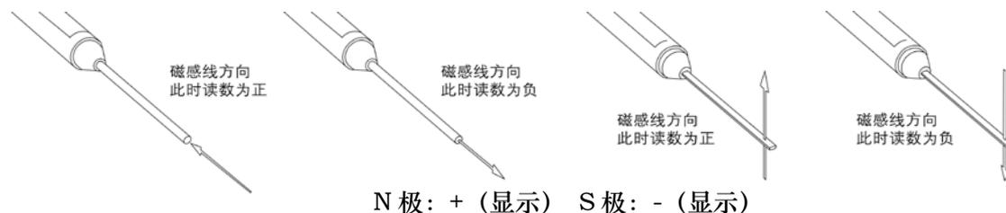
为达最佳效果，使用前仪器和探头应至少预热 5 分钟，预热 30 分钟后达到额定精度。严格测量前，探头应首先校零，以消除探头零点漂移或环境微小磁场的影响。温度也将影响探头精度，请尽量将探头置于 20℃ 附近温度下使用。
