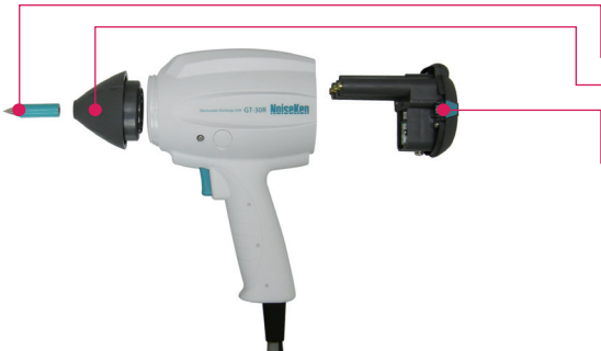
■放电枪 ISO 套装 型号：GT-30R3302KA 细项：放电枪（带 330 Ω 测试用放电罩）· 放电枪（2 kΩ 先端放电罩） · CR 组件 06-00073B/74B/75B/76B· 放电电极（圆锥 / 圆 / 球体）
