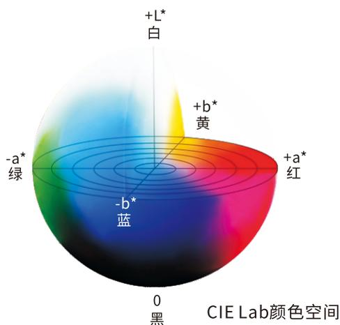
分光测色仪内有CIE LAB,XYZ,Yxy,LCh,CIE LUV,s-RGB,HunterLab,βxy,DIN Lab99等多个颜色空间可供选择,例如常见的CIE Lab颜色空间:
