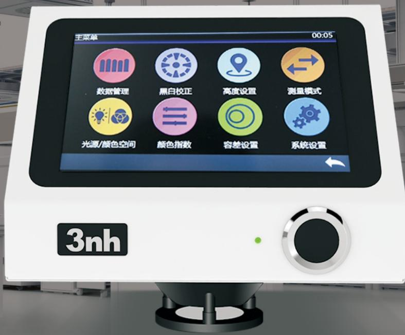
在线台式分光测色仪YL4668L是一款采用D/8(漫射照明,8°方向接收,SCI包含镜面反射光)标准的颜色测量仪器,测试探头和被测样品非接触测试,实现液体、酱状物、粉末等非接触精密测色。简洁的测头设计使得这款产品可放置于自动化生产线上任何位置用于精确颜色测量、色彩质量控制,在化妆品、果蔬、食品卫生、塑胶电子、油漆油墨、印刷、陶瓷等行业均有广泛应用,可用于荧光样品测量。它独特的创新设计不仅能直接从生产线上提供非接触式的测量方案,还能够保证稳定而高精度的测量结果。
