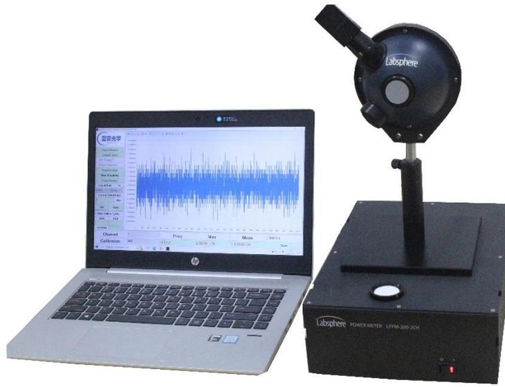
蓝菲光学LFPMS激光功率测量系统专为激光束总功率测量而设计，是测量光纤激光、激光二极管或其他类似光源发散光束总功率的理想选择。LFPMS系统标准组成包括激光功率测量积分球、探测器、辐射功率计、柱座组件和配套软件。
