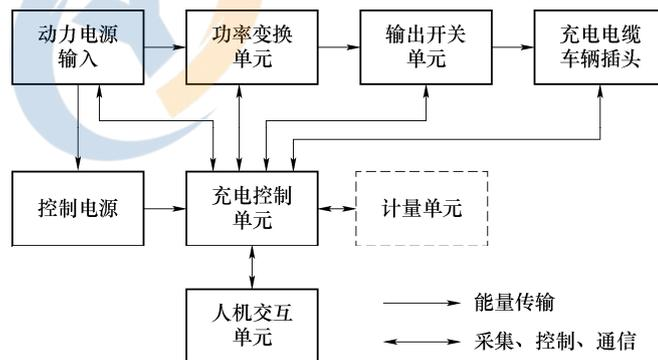
图 1 充电机构成原理框图
