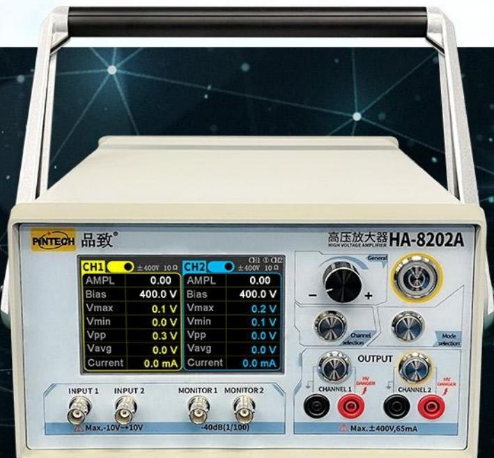
HA-8202A是一台非常实用的高电压讯号放大器，具备两个独立通道，支持同步输出控制和差分输出控制，它具有最简易的操作，非常高的电压输出(800Vp-p)等优点，连续输出电流最大可达65mA。输出保护开关，当选择保护输出时能确保本机不会外部短路，或外部电压回馈而导致损坏，因此可大幅降低不良率，延长本机的使用寿命。
