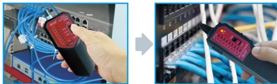
直接将待寻的带有水晶头的网络线接入发射器RJ45接口；把接收器的寻线开关拨到“寻线”位置，寻线的“电源”指示灯点亮，表示接收器工作正常，然后拿着接收器，用探头靠近线缆，用接收器的探头查询需要的目标线缆；
