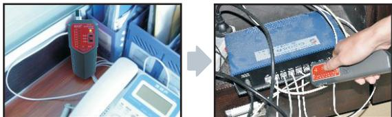
直接将待寻的带有水晶头的电话线接入发射器RJ11接口；把接收器的寻线开关拨到“寻线”位置，寻线的“电源”指示灯点亮，表示接收器工作正常，然后拿着接收器，用探头靠近线缆，用接收器的探头查询需要的目标线缆；
