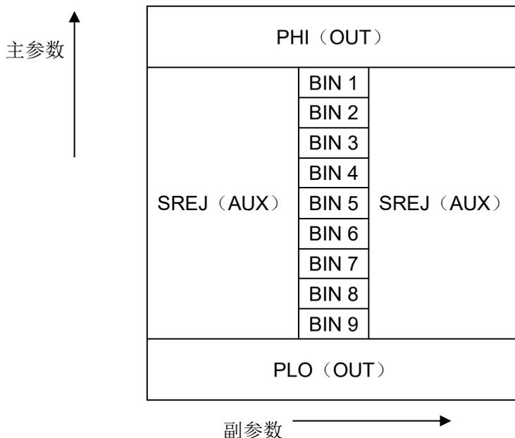
图 1 档比较功能/PHI， /PLO， /SREJ 信号的分配区域示例
