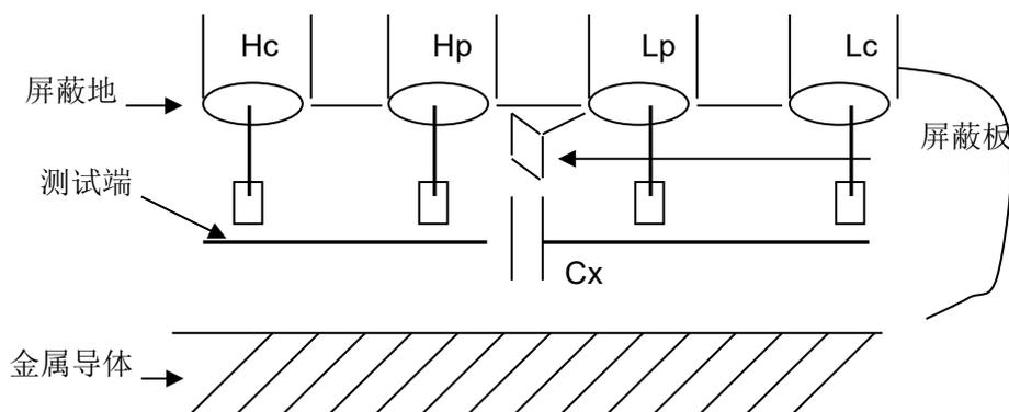
图 5-2 消除杂散电容影响方法示意图
