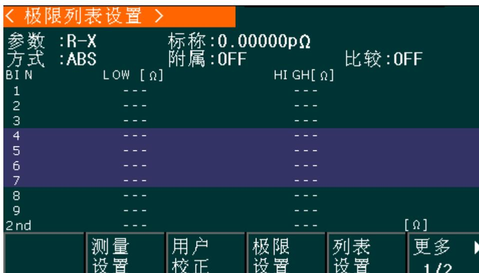
在该页面可以对仪器比较器功能进行设置。TH2817B+可设定 9 个主参数的档极限以及一个副参数的档极限值。被测结果可分选成最多 10 个档（BIN1 至 BIN9 和 BIN OUT）。如果被测件的主参数在 BIN1 至 BIN9 的极限范围内，但是其副参数不在极限范围内，这时被测件被分选到附属档中。当 TH2817B+ 安装了 HANDLER 接口，并运用在自动测试分选系统时，比较功能特别有用。下列比较功能的极限参数只能在<极限列表设置>页面进行设定。
