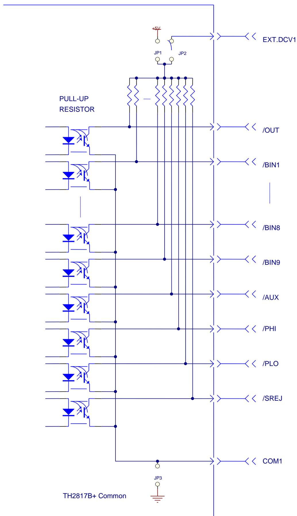
控制信号输出电路
