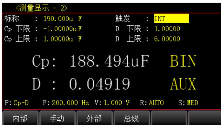
内置比较功能可将被测元件分成最多达 10 个档 (BIN1 至 BIN9 及 BIN OUT)。可设定 9 对主参数极限和一对副参数档极限。
