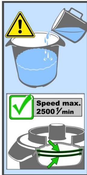
图 14：针对稀液状样品的最大转速
