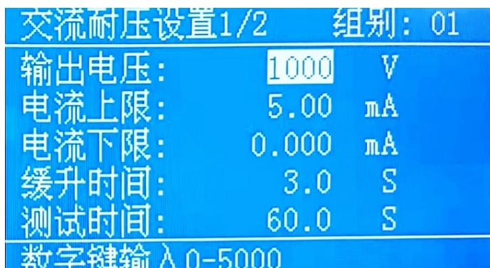
按设置键进入交流输出电压参数设定：
