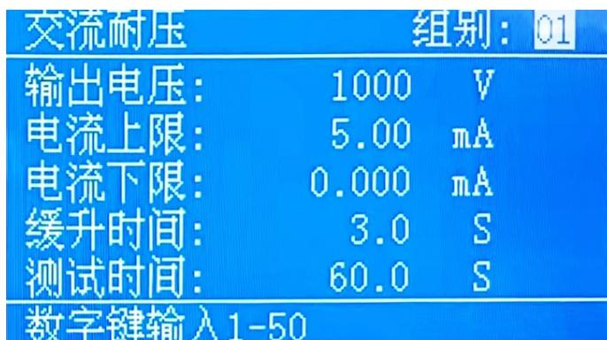
请用数字键输入的测试程序记忆组 1-50，再按确定键，执行程序会读出该测试程序记忆组内所储存的设定参数，并回到待测模式，可依照所读出的测试参数执行测试。在待测状态下可按 $\Delta$ 或 $\nabla$ 键增加或减少测试组别值，并读出相应的设置数据，以供使用。组别数据后的“\_”是该组别数据是否连接到下一个组别。
