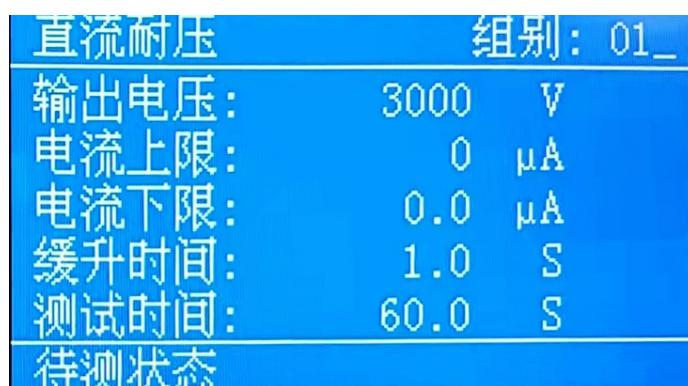
再按设置键进入参数设定模式， $\wedge$ 或 $\vee$ 键作为选择参数项目操作键。该参数的设定项目依序为：直流输出电压(单位为 1V / step)、直流电流上限设定(单位为 1uA / step)、直流电流下限设定(单位为 0.1uA / step)、缓升时间设定(单位为 0.1S / step)、测试时间设定(单位为 0.1S / step)、最低充电电流、缓冲电
