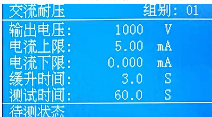
按设置键进入参数设定模式， $\wedge$ 或 $\vee$ 键作为选择参数项目操作键。该参数的设定项目依序为：交流输出电压(单位为 1V / step)、交流电流上限设定(单位为 0.01mA / step)、交流电流下限设定(单位为 0.001mA / step)、缓升时间设定(单位为 0.1S / step)、测试时间设定(单位为 0.1S / step)、输出频率、电弧侦测、电弧等级、电流归零、步骤连接。
