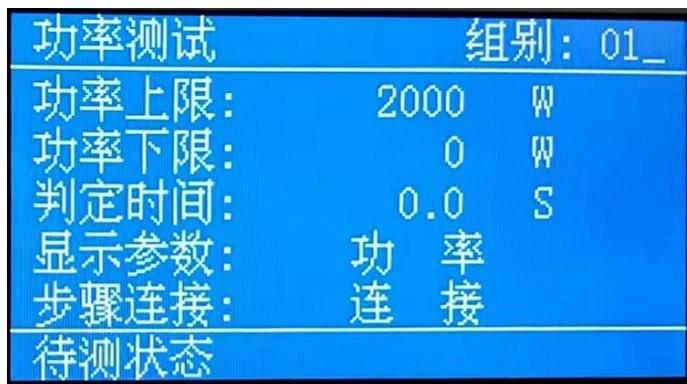
再按设置键进入参数设定模式， $\wedge$ 或 $\vee$ 键作为选择参数项目操作键。该参数的设定项目依序为：功率上限设定(单位为 1W / step)、功率下限设定(单位为 1W / step)、测试时间设定(单位为 0.1S / step)、显示参数、步骤连接。
