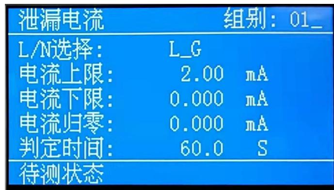
再按设置键进入参数设定模式， $\wedge$ 或 $\vee$ 键作为选择参数项目操作键。该参数的设定项目依序为：测试棒选择(N\_G 或 L\_G)、电流上限设定(单位为 0.01mA / step)、电流下限设定(单位为 0.001mA / step)、电流归零设定(单位为 0.001mA / step/TEST)、测试时间设定(单位为 0.1S / step)、电源选择、步骤连接。
