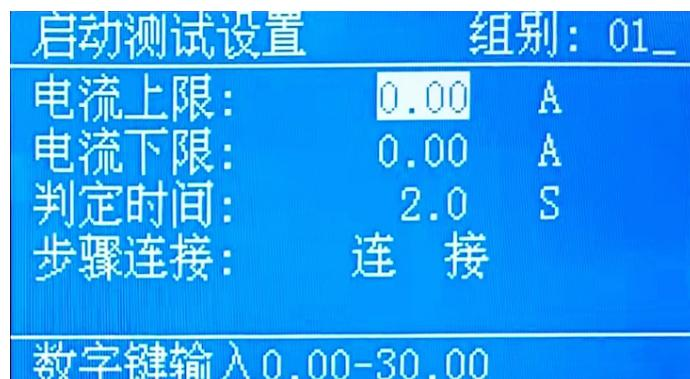
再按设置键进入参数设定模式， $\wedge$ 或 V 键作为选择参数项目操作键。该参数的设定项目依序为：电流上限设定(单位为 0.01A / step)、电流下限设定(单位为 0.01A / step)、测试时间设定(单位为 0.1S / step)、步骤连接。
