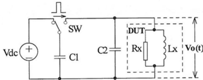
图 1.2.1-1 线圈层间短路测试原理简图
