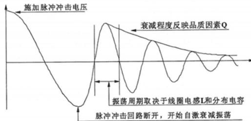
图 1.4.1-2 线圈衰减振荡波形分析
