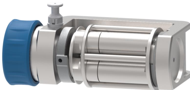
图42：研磨杯架中 4 个 5 ml 钢质研磨杯的适配器
