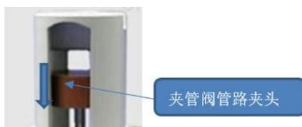
图 4.12 更换夹管阀硅胶管(2)
