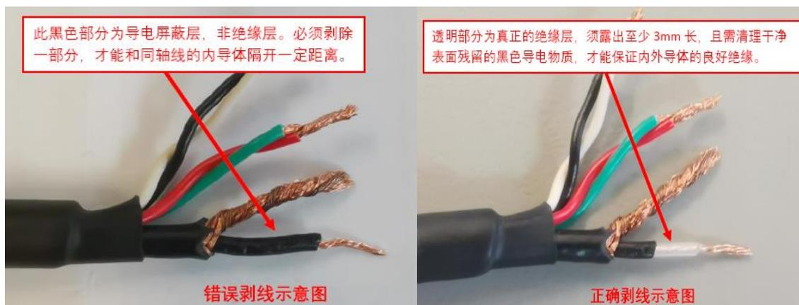
图 2.59 内部屏蔽电缆剥线示意图
