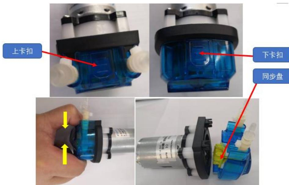
图 4.3 拆卸蠕动泵泵头
