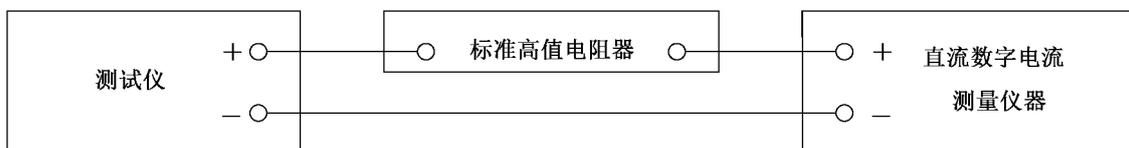
图 1 电流表法校准起始动作电压接线图
