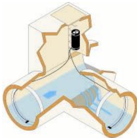
在某些情况下，有些 CSO 应用中的溢流湍流程度很强，很难进行准确的测量。图 6 显示的带有两个深度/速度传感器的 920 型流量计，它将测量上游和下游出水的流量，从而确定溢流的体积和持续时间。
