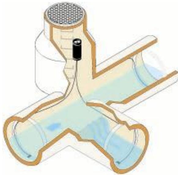
有时需要对检查井的流量测定进行多次测定和校核。在图 7 中，1 个 920 型流量计可以提供帕歇尔量水槽中的超声波流量测量，也可以使用连续性方程 ( $Q=AV$ ) 测量上游的流量。这可以确保在浸没式流量条件下不会丢失数据。
