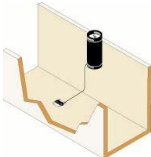
当合流管道的溢流有助于精确测量时，920 型流量计可以在主设备中测量深度和速度，在溢流通道中测量排放量，准确度可达到±5%。见图 5。
