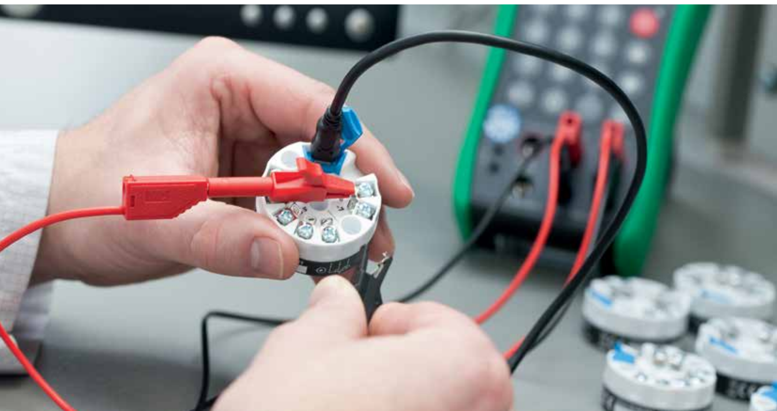
对 OPTITEMP 变送器模块组态
