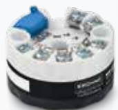
OPTITEMP TT 51 C、TT 51 C Ex* OPTITEMP TT 51 R、TT 51 R Ex* 高精度，通用的、可组态的两线制 HART® 变送器模块，适用于热电偶 或热电阻，电流输出，符合 IEC 61508:2010 标准的 SIL2 认证
