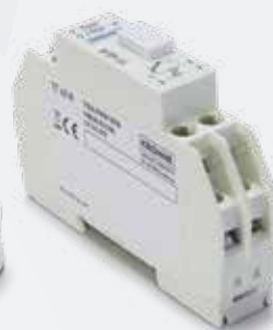
OPTITEMP TT 40 C OPTITEMP TT 40 R 高精度，通用的、可组态的两线制变送器 模块，适用于热电偶或热电阻，电流输出
