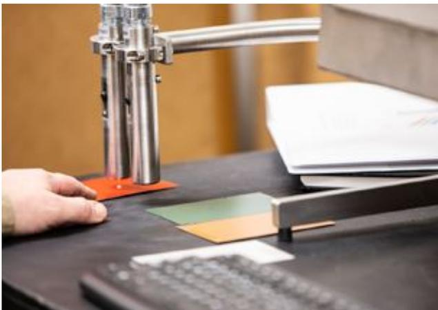
▲ 易于使用的 SpecMetrix 系统软件可更快地获得 DFT 干膜厚度测量结果，并提供为底漆和面漆设计专用的双探头。
