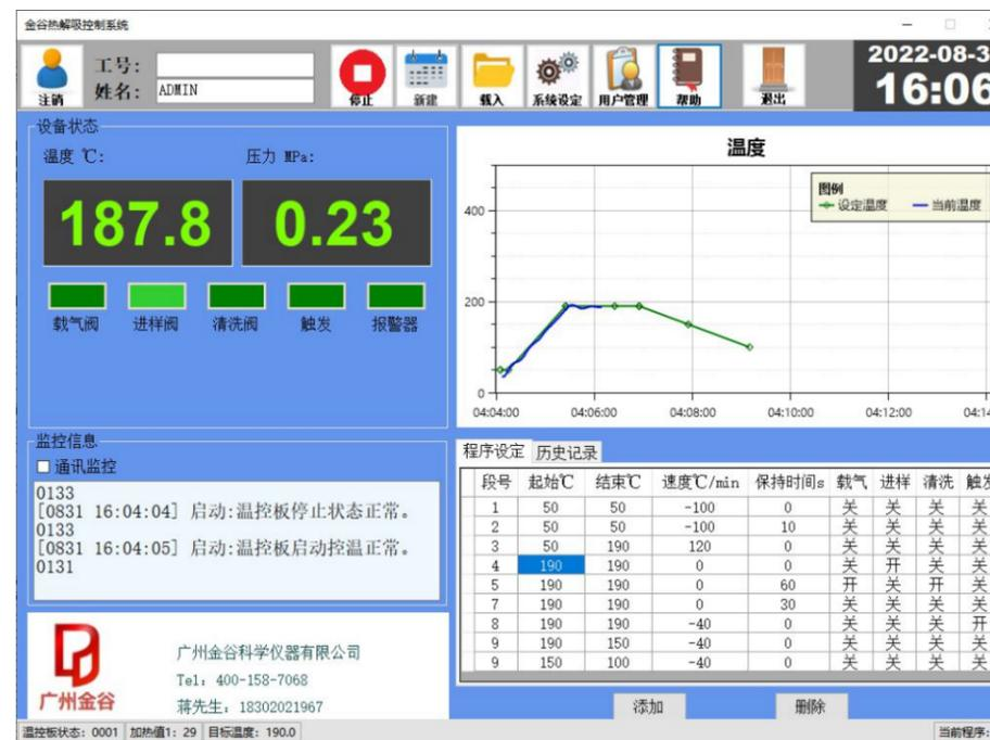
1.6 "金谷热解吸控制系统"已经测试运行OK,暂时最小化。待在电脑上设置气相色谱工作站软件与气相色谱仪联机调试后就可以开始测样了。
