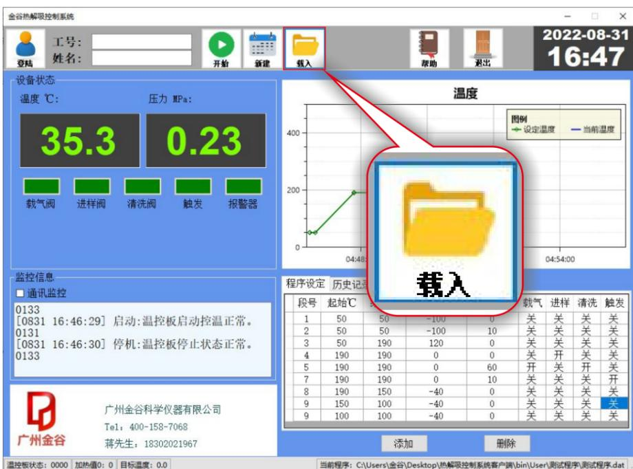
1.3 在弹出的打开对话框里双击"测试程序"文件夹，再双击"测试程序.dat"文件(如下图箭头所示)，加载测试程序。
