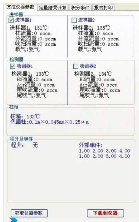
如在该界面中，各个参数被设计成只读方式。您可以通过对仪器参数的设置（详见前面的仪器的设置）点击“获取仪器参数”按钮加载到本界面中来，成为方法中的仪器参数。它将记载产生本通道分析结果的仪器运行条件。在进样器1、进样器2、检测器1、检测器2前面后打勾选择框。该选择表示本数据通道是使用哪个进样器以及哪个检测器。该选择将保存在该通道的“方法”里。在谱图的后处理时，您会看到产生该谱图的仪器条件。
