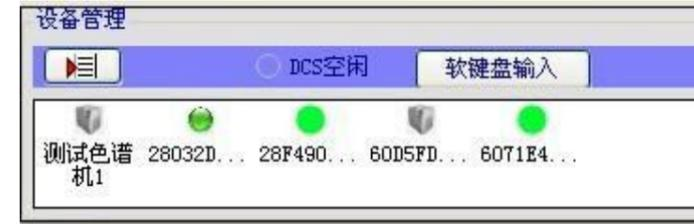
“设备管理”栏中显示了系统以前所连接的色谱仪（或其他分析仪器）的信息。灰色图标表示该仪器现在没有连接，彩色图标表示该仪器已经连接上，方框上有红勾则表示主界面显示的是该台仪器的谱图曲线和仪器参数等信息。如想查看其他仪器的谱图曲线和色谱仪参数双击其对应的图标即可。如在某一图标上点右键，再点“编辑”，则弹出色谱仪基本信息的编辑界面（如下图）。
