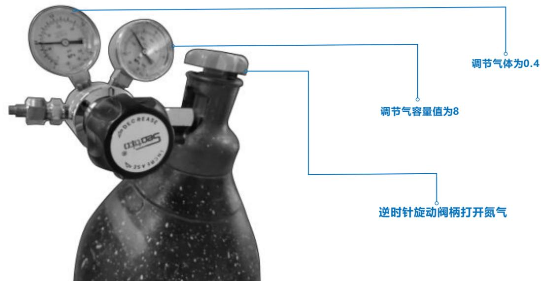
**注意：**当气容量低于2时，表示氮气容量低，应立即更换气瓶！
