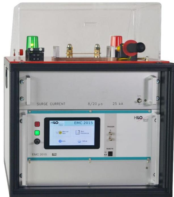
脉冲发生器系统 EMC 2015 是根据 IEC、VDE 等标准设计用于电气元件、过电压保护器和电子电路介电测试。基础版本产生带波形 8/20 $\mu$ s 和波峰值高达 25kA 的脉冲电流。
