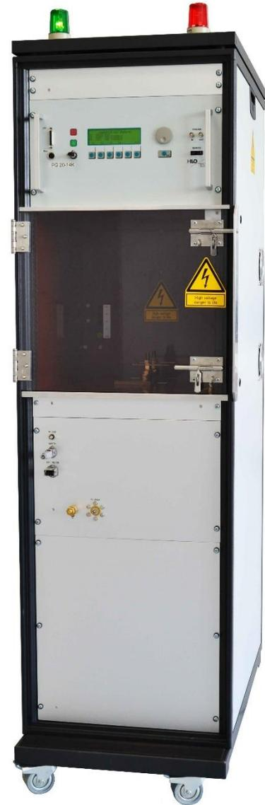
浪涌电流发生器 PG 20-10k 根据 IEC, EN, VDE 生成波形为 8/20  $\mu$ s 的标准脉冲电流。脉冲电流输出幅度由预设的充电电压控制，最高可调节至 70 kA。
