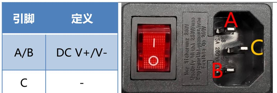
注：当输入电源为直流时，电源的正负极分别连接图示“A/B”引脚（因设备内置整流桥，因此可不区分正负极）
