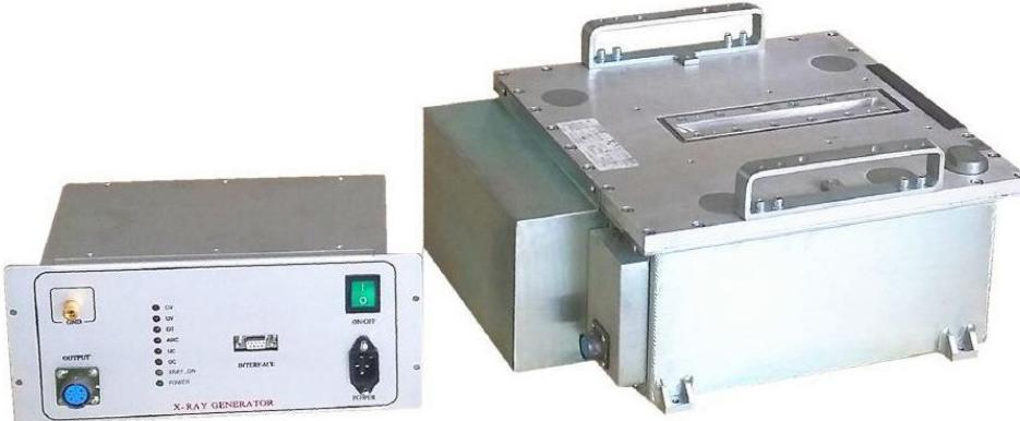
XRT03A 160kV X 射线源产品由控制器、射线源两部分组成。采用最新PWM 中高频脉宽调制技术，管电压、管电流高精度闭环控制；独有的电源输入预稳设计能有效消除电网波动的影响，使射线输出更稳定；设有过压、过流、过热等多种保护及良好的射线屏蔽。工作可靠安全，使用方便，出束稳定，射线泄漏剂量低。广泛应用于安全检查、食品检测、工业检测等领域。
