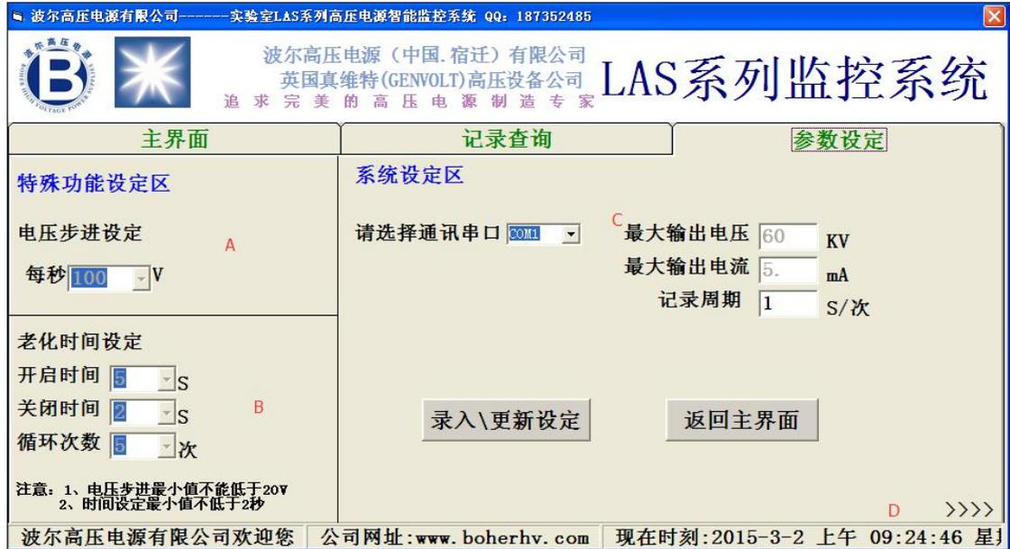
A 区：电压步进设定，最小值不得低于 20V。
