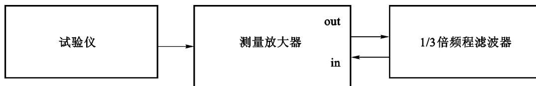
图 1 白噪声、粉红噪声信号频谱特性校准示意图
