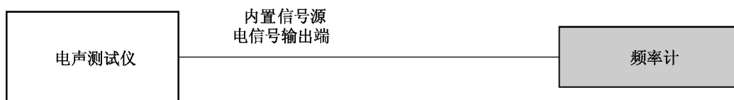
图 1 信号源频率范围及示值误差校准示意图
