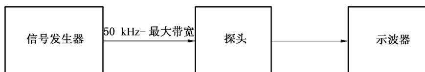
图 D.1 使用 FFT 功能校准频率响应
