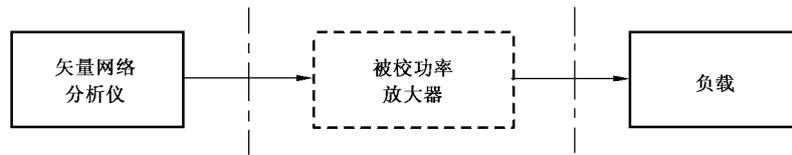
图 11 输入电压驻波比校准框图
