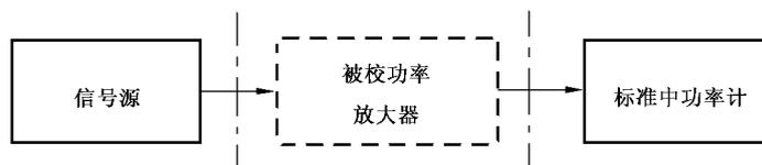
图 1 标准中功率计法校准额定输出功率校准框图
