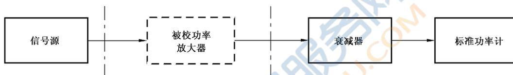
图 2 衰减器法校准额定输出功率校准框图
