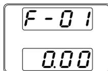
3. 旋转电压旋钮，改变 F 设置
