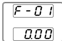
3. 旋转电压旋钮，将 F 设置调节到 F-88 (出厂设置值)
