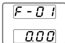
3. 旋转电压旋钮，将 F 设置调节到 F-89 (显示版本)
