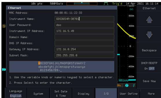
7. 使用右侧菜单上的 Up 和 Down 方向键或使用前面板上的数字键盘导航到每个以太网配置项。
