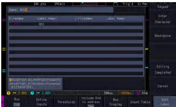
5. 使用 *VARIABLE* 旋钮突出显示字符。
