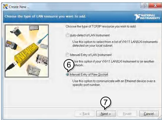
8. 输入 GDS-3000A 的 IP 地址和 socket 端口号。
