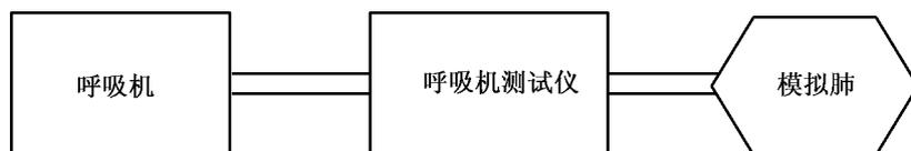
图1 呼吸机校准系统连接示意图
