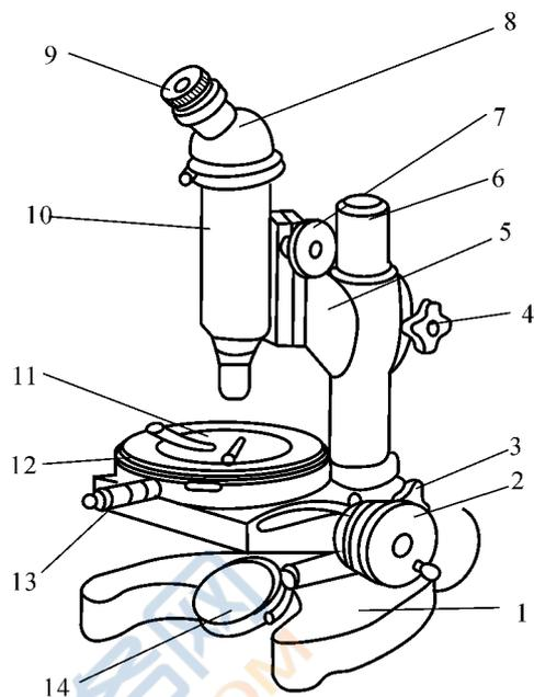
图4 测量显微镜外形图
