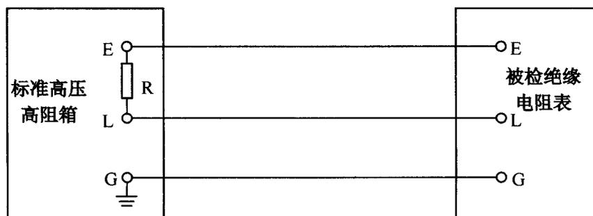
图2 绝缘电阻表基本误差检定接线图
