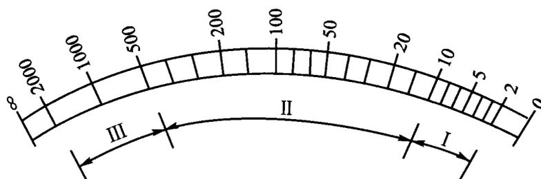
图1 绝缘电阻表量程区段
