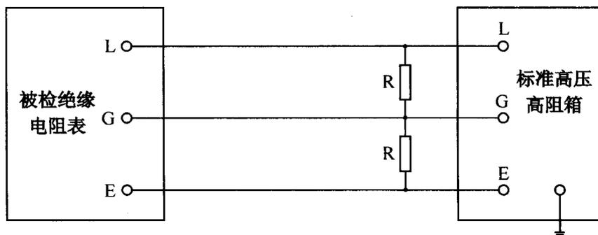
图 4 检查屏蔽装置作用的接线图
