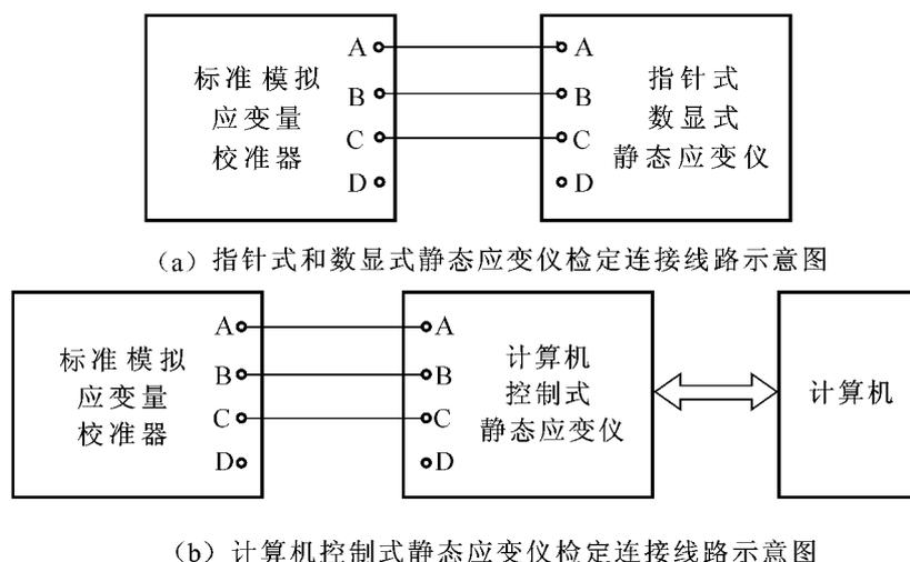
图1 静态应变仪检定连接线路示意图
