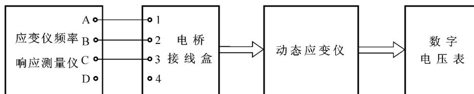
图 3 交流供桥型动态应变仪频率响应检定连接线路示意图
