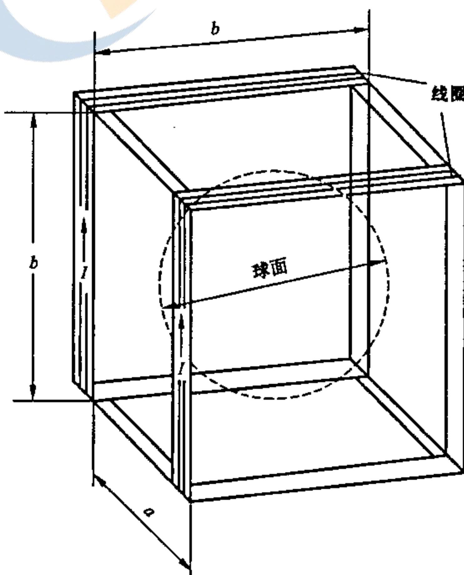
$n$ —每个线圈的匝数;  $a$ —线圈间的距离(m);  $b$ —线圈的边长(m);  $I$ —电流值(A);
