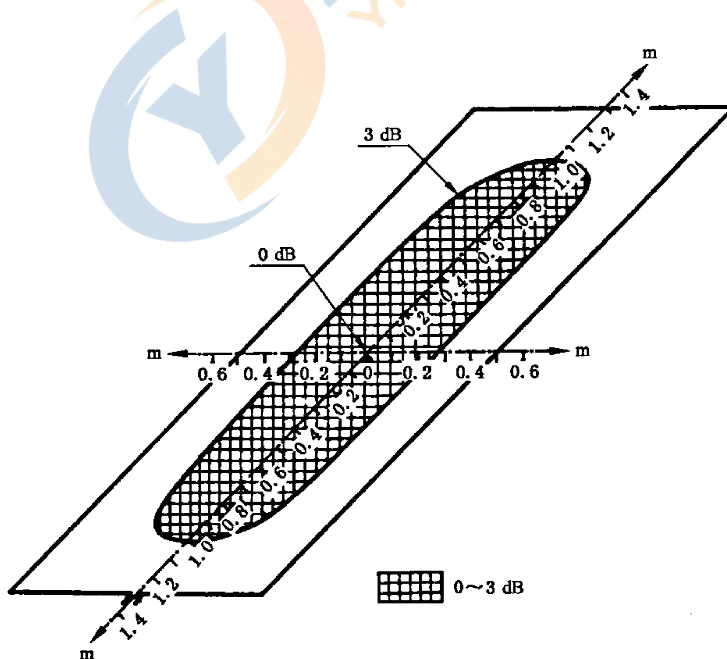
图 B.6 矩形( $1 \text{ m} \times 2.6 \text{ m}$ )感应线圈在其平面上产生磁场的  $3 \text{ dB}$  区域
