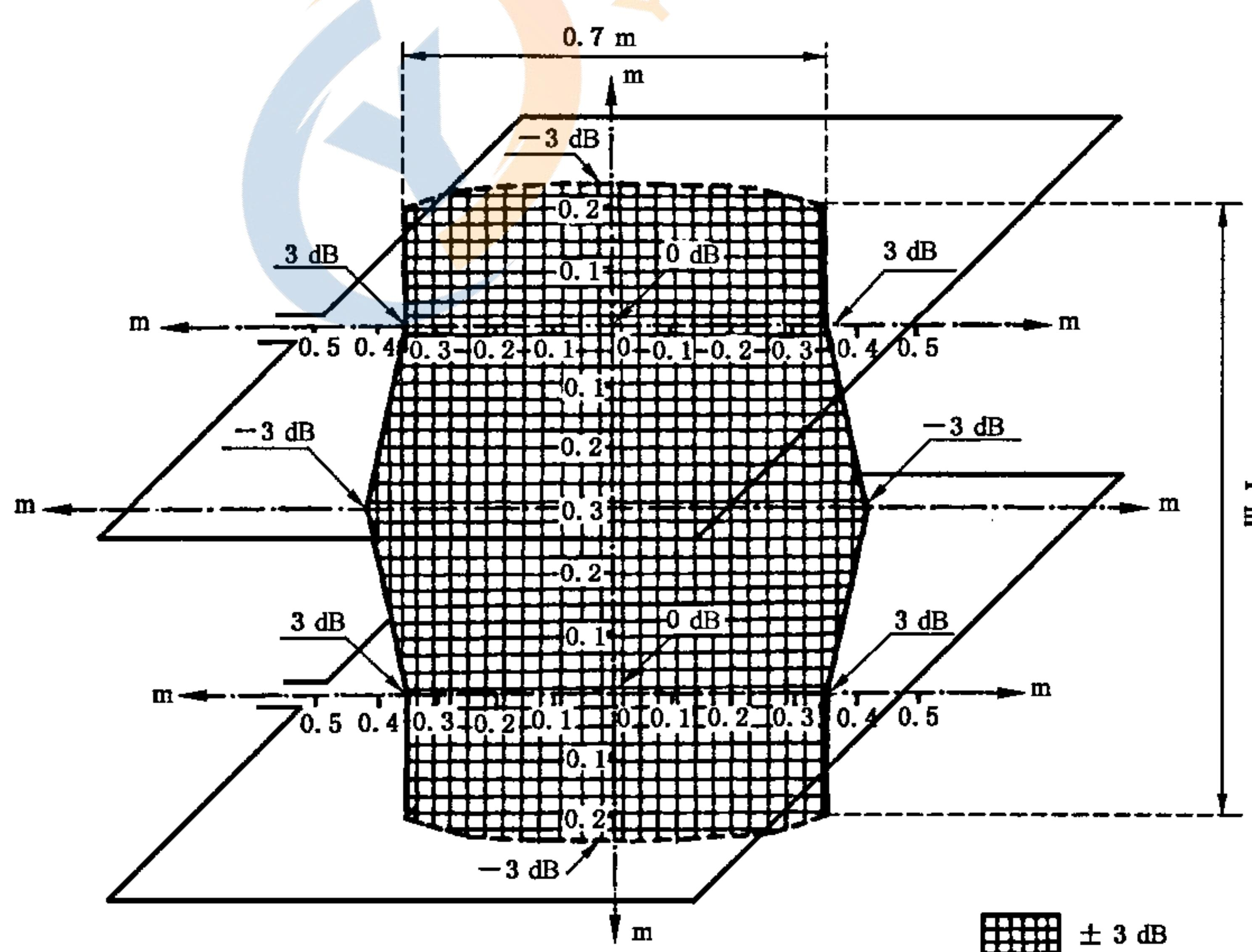
图 B.4 两个相距 0.6 m 的正方形(边长为 1 m)感应线圈在中央垂直平面上产生磁场的 3 dB 区域(垂直于线圈平面的分量)
