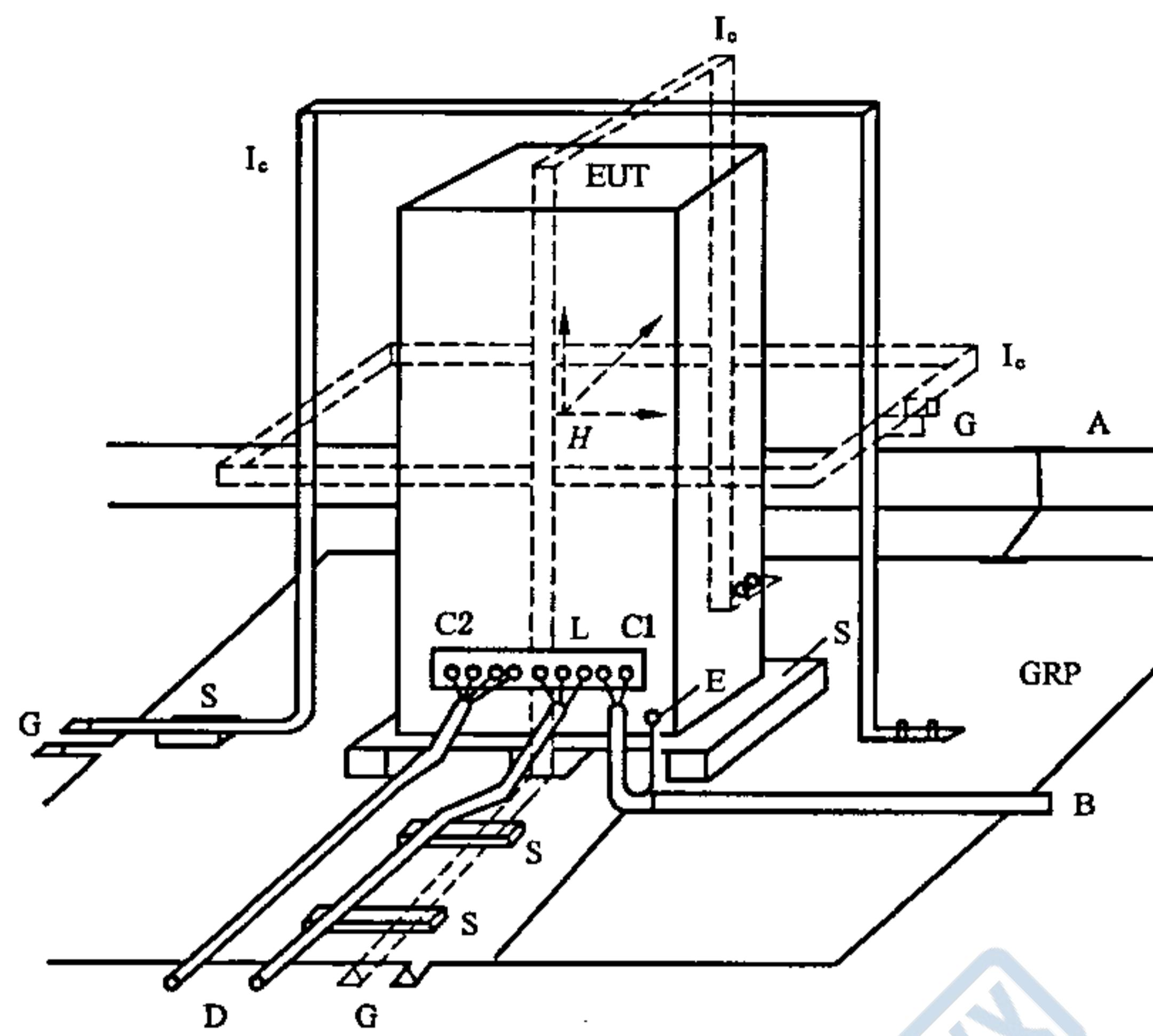
GRP—接地平面; C1—供电回路; A—安全接地; C2—信号回路; S—绝缘支座; L—通信线路;
