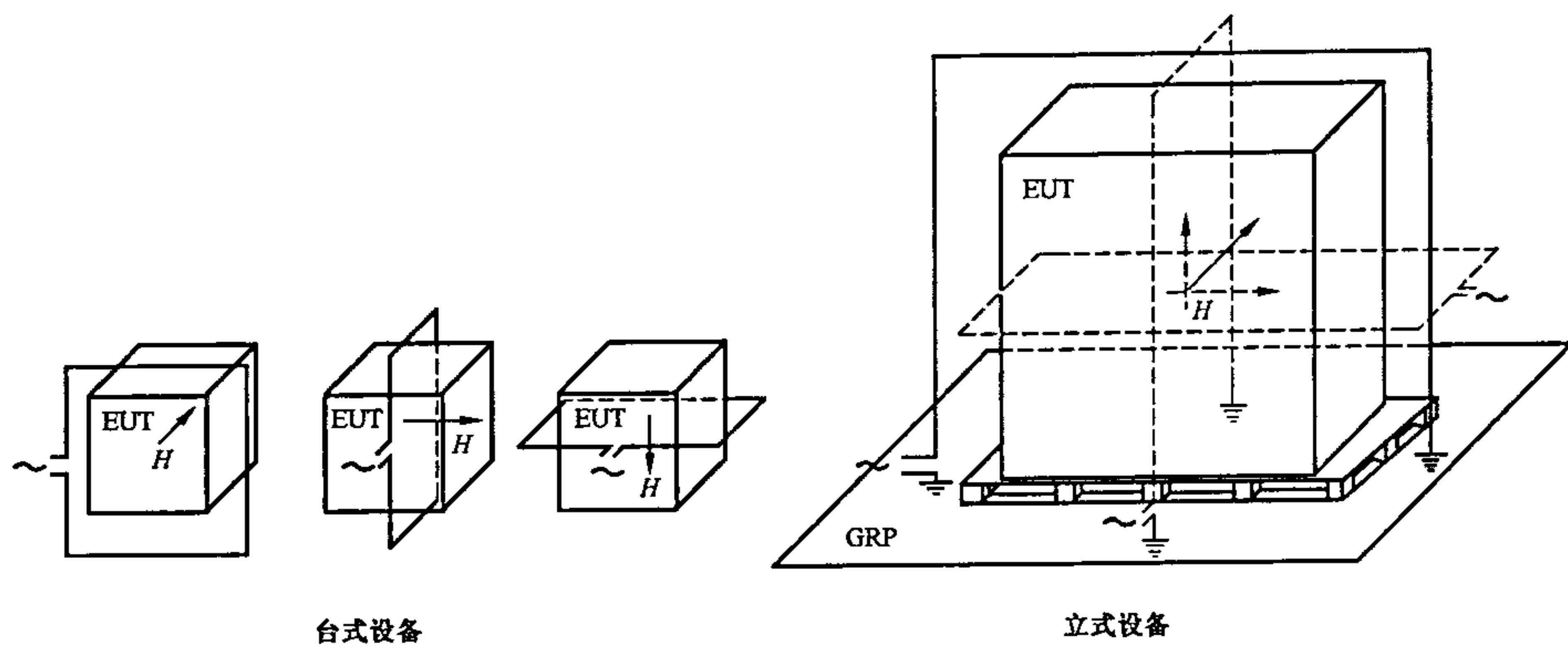
图 1 用浸入法施加试验磁场
