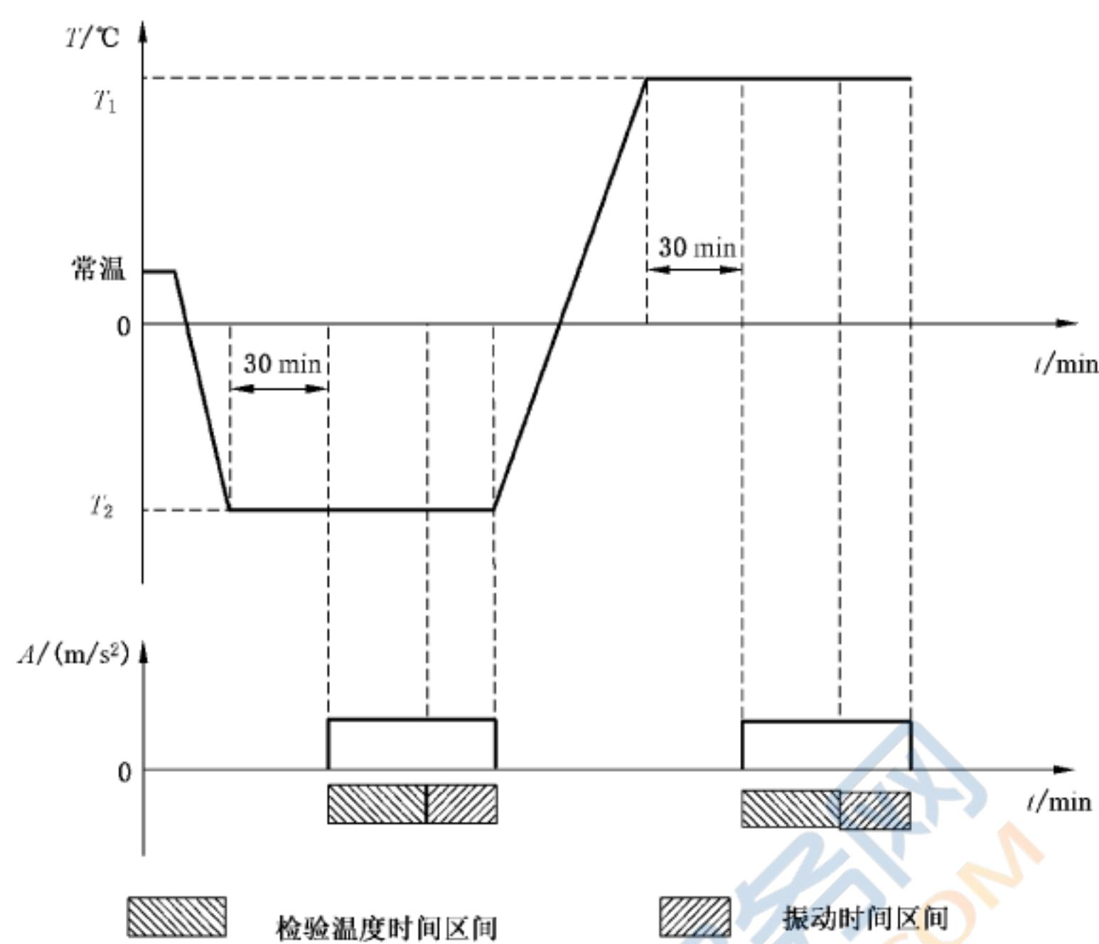
图 2 温度振动检验时序剖面图
