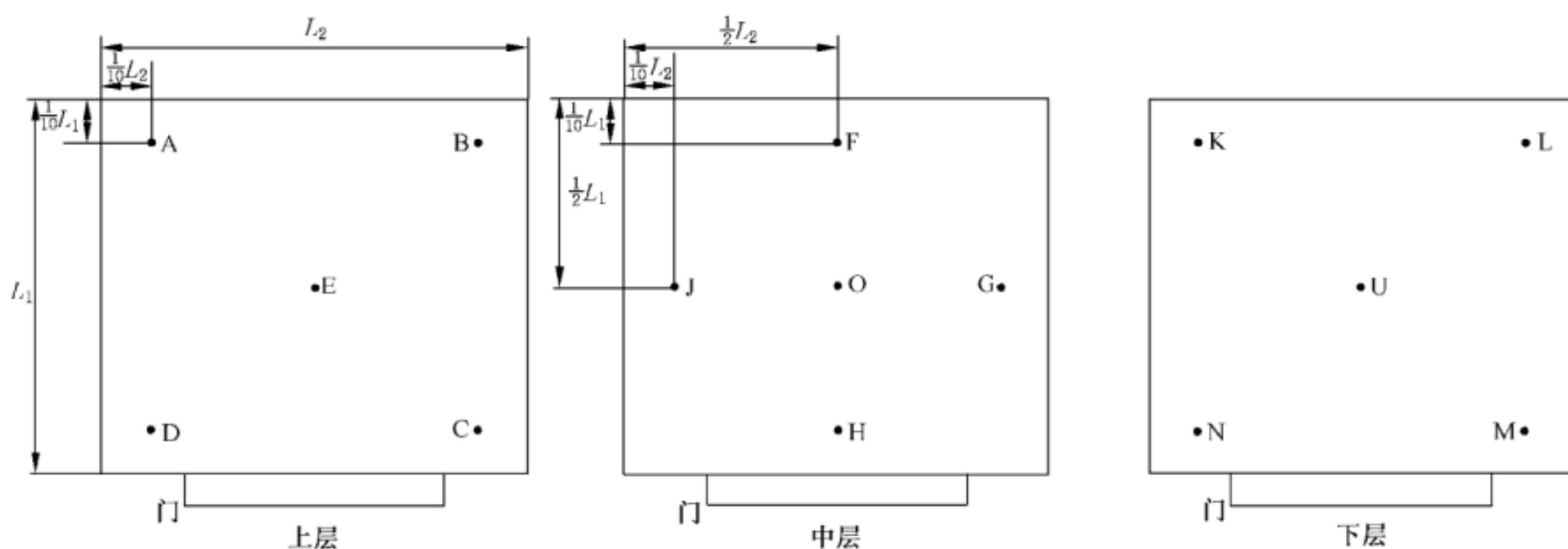
注:图中 O、A、B、C、D、E、F、G、H、J、K、L、M、N、U 为温度测量点位置。 $L_1$  试验箱(室)深度,单位为毫米(mm); $L_2$  试验箱(室)宽度,单位为毫米(mm)。
