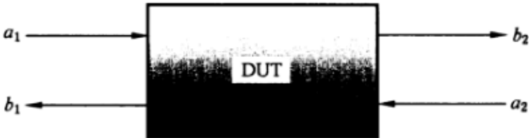
图 2 DUT 信号传输与反射示意
